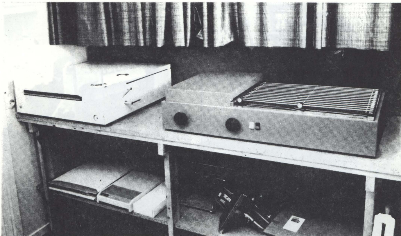
Plåtmaskiner är en viktig del i den tekniska utrustningen när man gör offsettidningar. I bänkhyllan syns en annan finesse — en eldriven häftmaskin.
